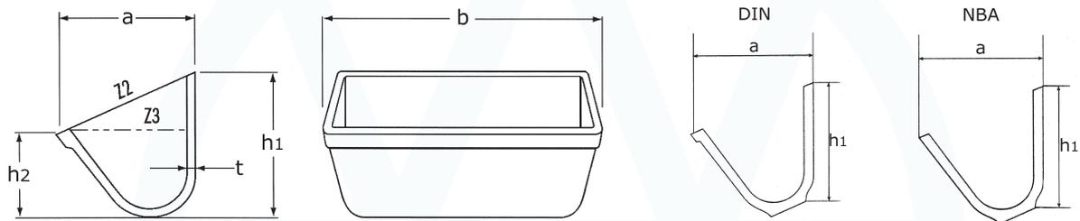
Monocast GSM-Elevatorbecher der NBA-Serie (Abmessungen in mm)
