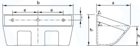
Kunststoffbecher Type M (Abmessungen in mm)
