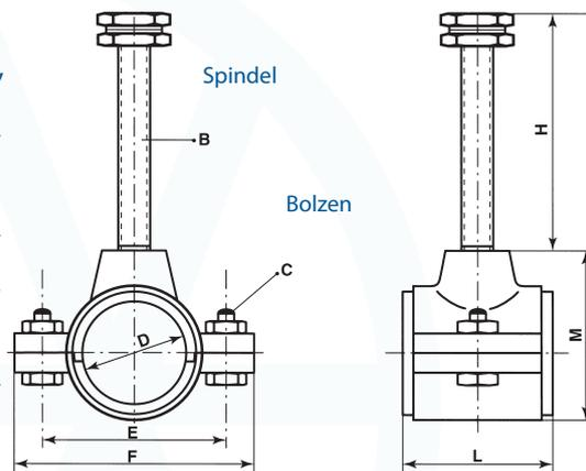
Verstellbare Mittellager (Abmessungen in mm)
