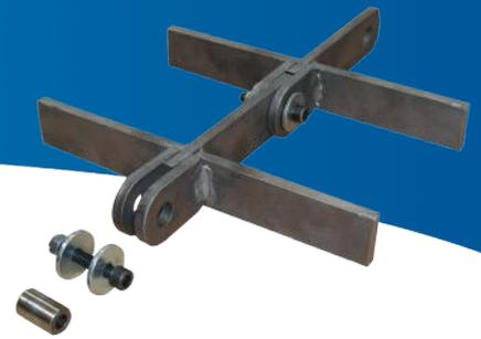
Die VO-Kette besteht aus verschweißtem Stahlblech in gabelförmigen Gliedern. Die Glieder lassen sich mithilfe eines Stifts und einer Inbusschraube leicht montieren und demontieren. Die Kette ist mit angeschweißten Mitnehmern aus gefalztem Material ausgestattet. Die Standardkettenbreiten betragen 260, 360, 460 und 560 mm. Zwischengrößen sind lieferbar.
